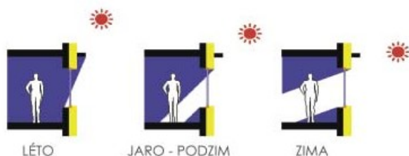
Obr. 4 Ochranu proti přehřívání interiéru v létě zabezpečuje stínění. Nejjednodušší je zvětšený přesah střechy – horizontální stínění. Další možnosti jsou nastavitelné venkovní žaluzie.
