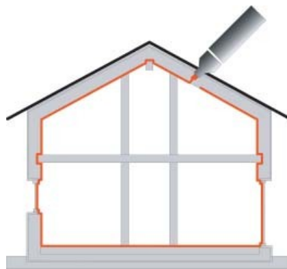
Obr. 5 Neprůvzdušnost zajišťuje spojitá vzduchotěsnicí vrstva, která musí být precizně vyhotovena. Kromě tepelných ztrát tato vrstva chrání konstrukce před vlivem vlhkosti, která se šíří přes netěsnosti.
